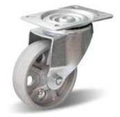
Усиленные кронштейны серии 3802-НТ изготовлены прессованием из 4 мм. листовой стали. Поворотный узел с двухрядным шарикоподшипником. Верхний ряд шариков без пластикового кольца пыльника с увеличенным интервалом между шариками. Все детали кронштейны смазаны специальной жаростойкой смазкой. Рабочая температура от -40°C до +300°C. Производство Россия.
