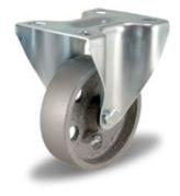
Колеса из серого чугуна, чрезвычайно устойчивого к абразивному износу. Ступица колес оснащена смазочным ниппелем. В оси колеса втулка скольжения. Крепление кронштейна площадка под четыре болта. Рабочая температура от -50°C до +350°C. Производство Турция.
