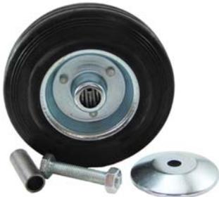
Стальной обод состоящий из двух половинок, скрепленных заклепками. Шинка - стандартная литая резина черного цвета, в оси колеса роликовый (игольчатый) подшипник. Поставляются в комплекте с двумя стальными колпачками, втулкой, болтом и гайкой. Рабочая температура от -25°С до +50°С.
